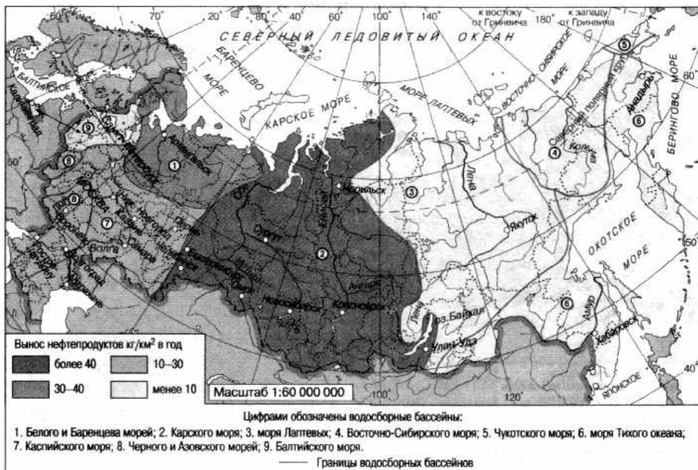
Рис. 73. Вынос нефтепродуктов с речным стоком ( $\text{кг}/\text{км}^2$  в год)
