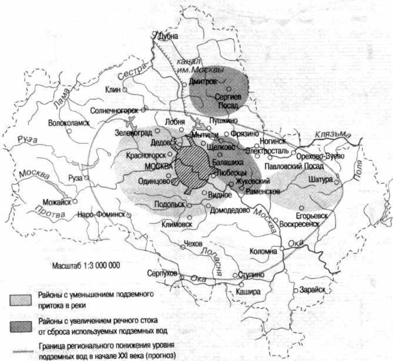
**Рис. 89.** Нарушение подземного притока в реки под влиянием интенсивной эксплуатации подземных вод в центральной части Московского артезианского бассейна
